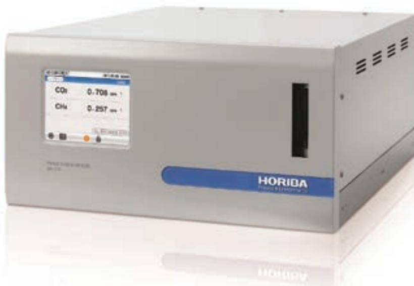
Analizzatore per la rilevazione di gas presenti in traccia (CO, CO<sub>2</sub> e CH<sub>4</sub>) all'interno di gas puri (N<sub>2</sub>, O<sub>2</sub>, He, Ar, H<sub>2</sub>) e in Aria
